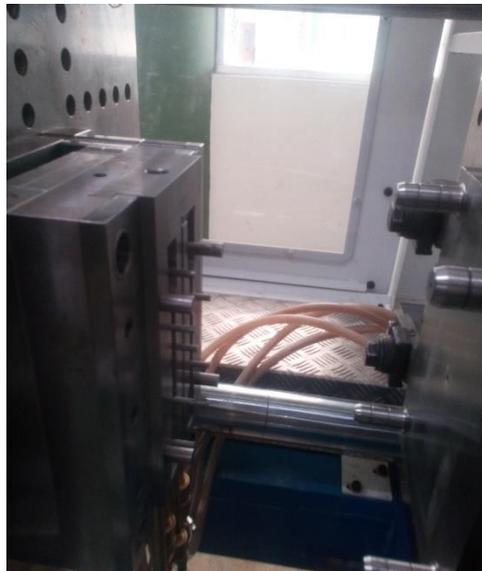
*Ilustración 41: Sistema de enfriamiento en el molde*
