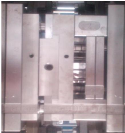
*Ilustración 1.34: Molde de inyección de probetas*
