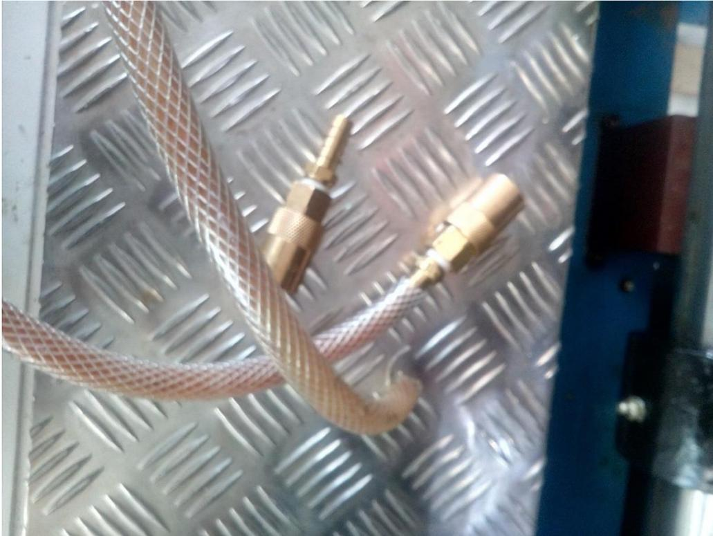
*Ilustración 2.10: Mangueras con conexiones rápidas*
