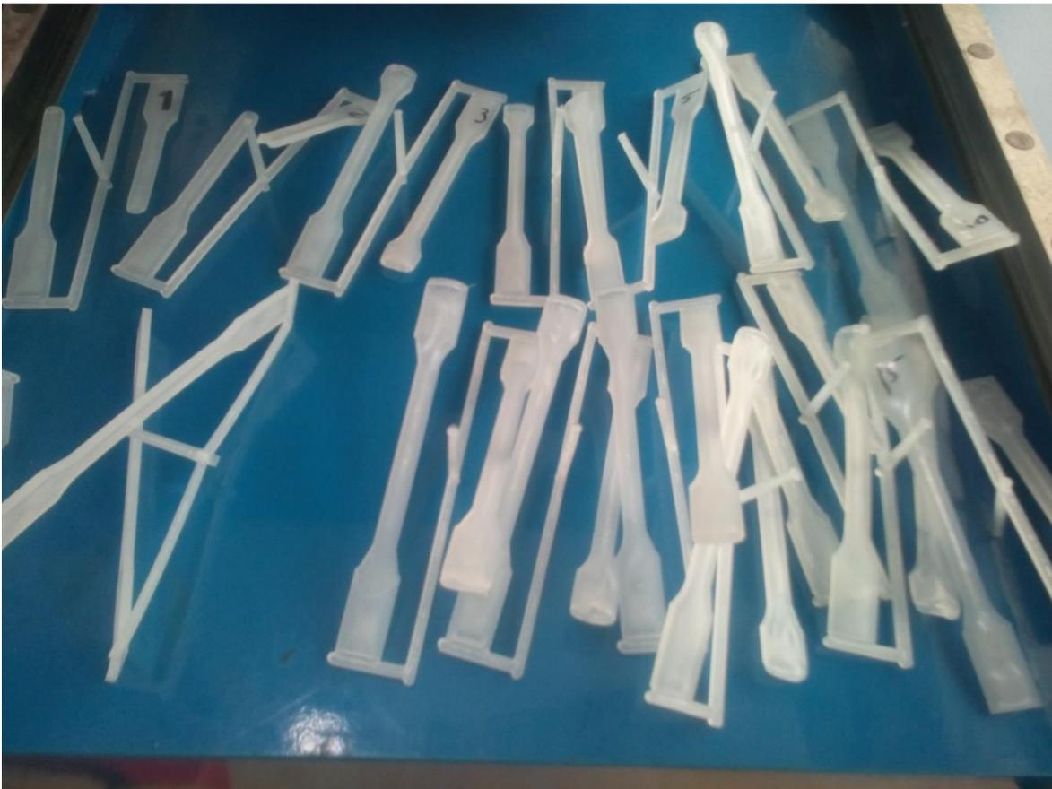
*Ilustración 51 Cambio dimensional de las probetas tras ajustar el defecto de conmutación.*
