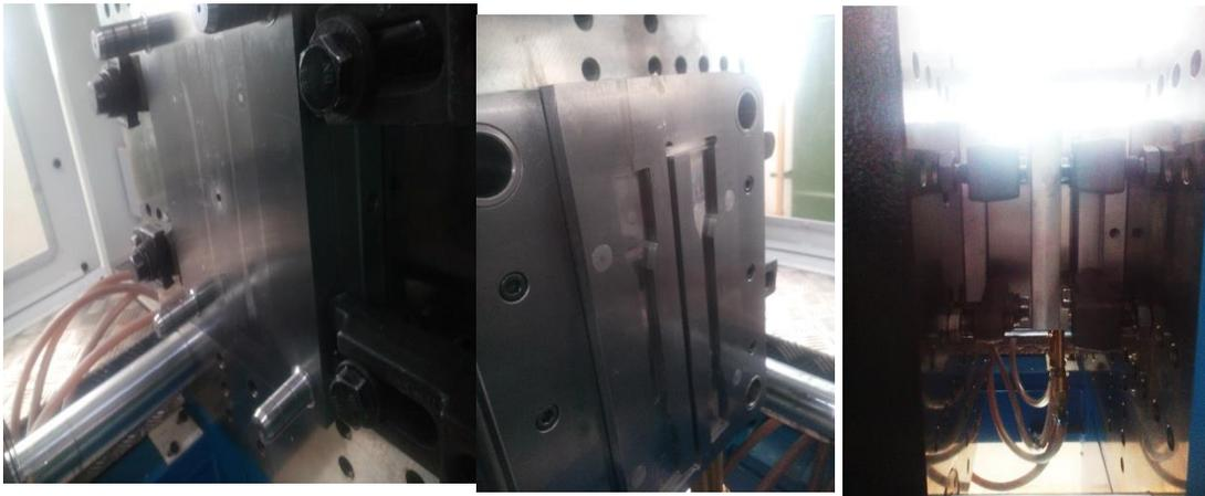
*Ilustración 50 Molde cerrado, ciclo de inyección.*
